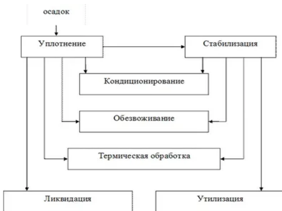
Рисунок 37. Технологический цикл обработки осадков сточных вод
